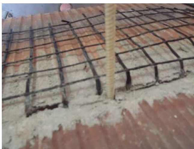
Фото 36. Анкер после испытания. Виден вырыв раствора из шва образца.
