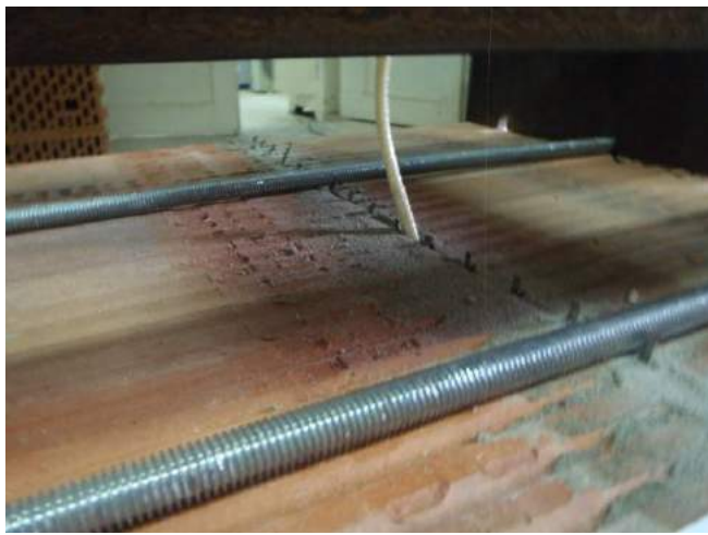
Фото 31. Образец-двойка из керамического камня РОJOMAX-200 со швом, армированным базальтовой сеткой 12 мм.
