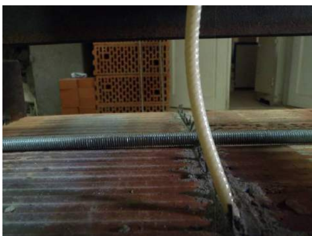
Фото 59. Положение анкера после сжатия в растворе шва под нагрузкой.
