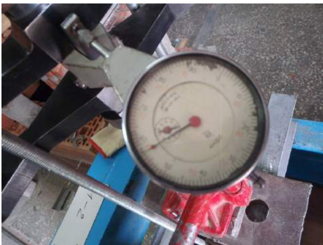
Фото 9. Величина нагрузки анкера фиксируется механическим динамометром сжатия ДОСМ 3-5.
