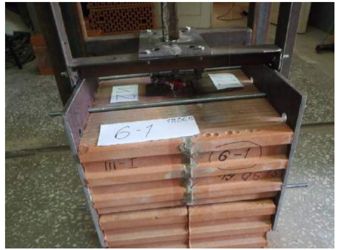
Фото 2. Стенд №2 для испытания композитных гибких связей на прочность при сжатии. Образец-двойка из керамического камня РОУМАХ-200 со стандартным раствором швом 10 мм.
