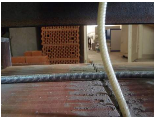
Фото 39. Критерием предельного перемещения анкера при сжатии в образце является величина, превышающая 5 мм или прогрессирующие деформации образца.
