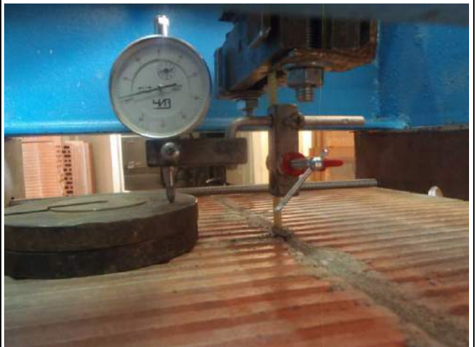
Фото 18. Фиксация перемещений полимерного анкера. Анкер после испытания. Виден вырыв раствора из шва образца.
