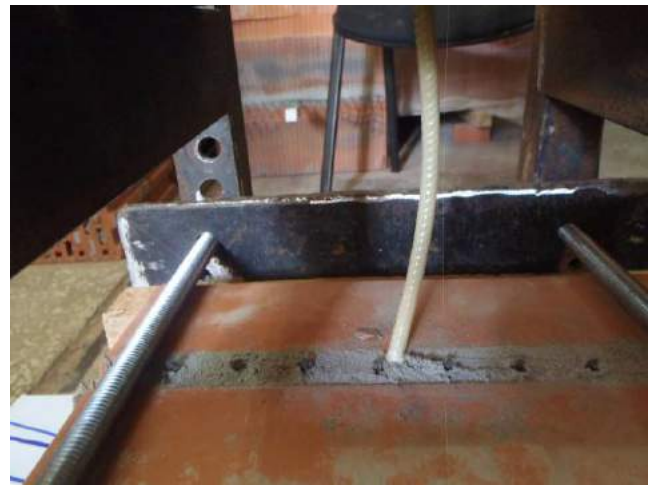
Фото 34. Положение анкера после сжатия в растворном шве.
