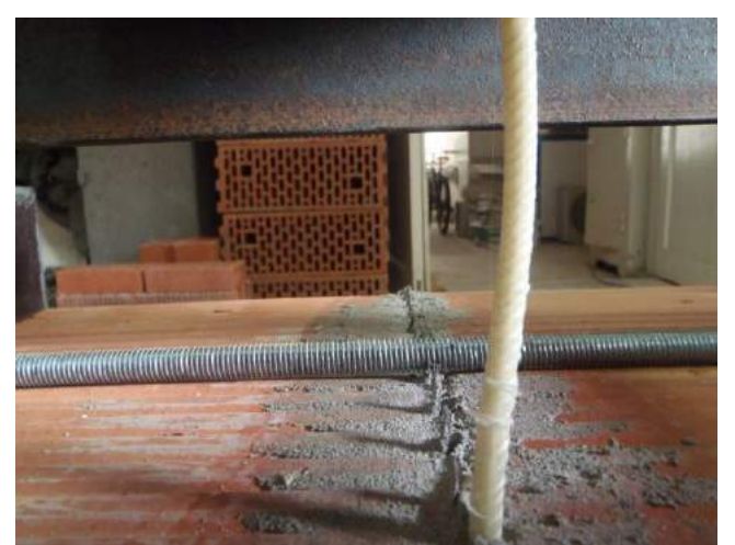
Фото 36. То же (см. ф. 35), видно отслоение наливки стержня при его сжатии.
