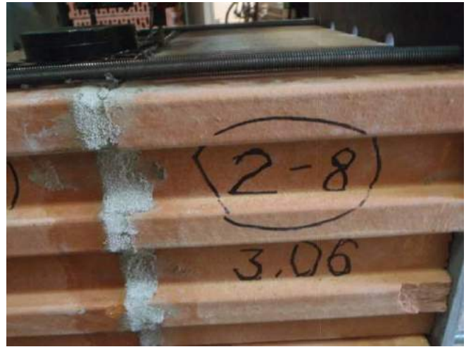
Фото 44. Образец-двойка из керамического камня Рогом ах-200 с базальтовой сеткой в растворе шва.
