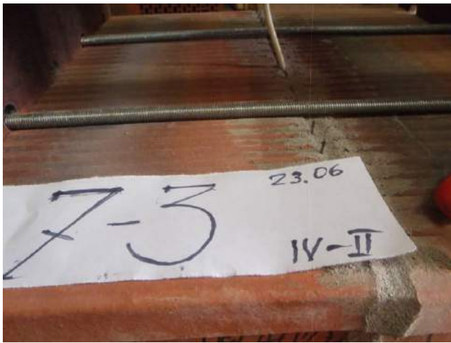
Фото 37. Образец-двойка из керамического камня Рогом ах-200 со швом, армированным базальтовой сеткой 12 мм.
