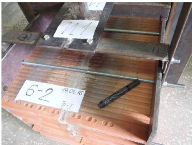
Фото 7. Испытание образца №2 серии 6. Шов не армирован.
