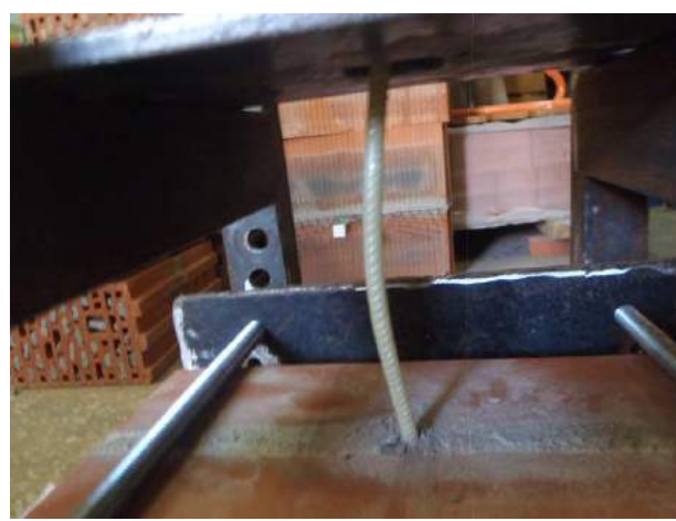
Фото 20. Положение анкера после сжатия. Видно выкрашивание частиц раствора из шва при действии нагрузки.
