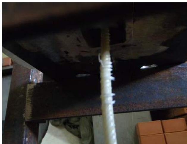
Фото 24. То же (см. ф23), другой ракурс. Видим обрыв стекловолоконного шнура полимерного стержня.
