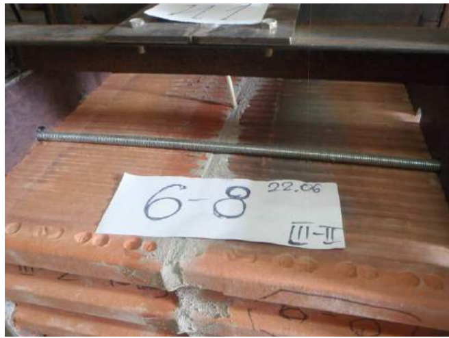
Фото 21. Образец-двойка керамического камня Рогом ах-200 со стандартным раствором швом 10 мм.
