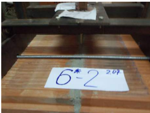
Фото 55. Образец-двойка из керамического камня Роюм ах-200 с укороченной заделкой стержня в стандартном растворе шве 10 мм.
