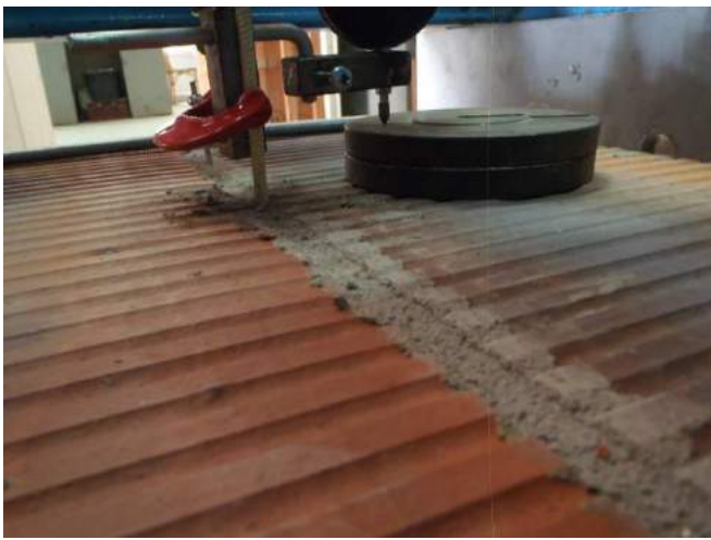
Фото 13. Положение анкера после испытания. Видно выкрашивание частиц раствора из шва при вытягивании.
