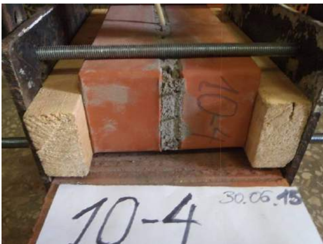
Фото 25. Испытание образца №4 серии 10. Образец-двойка кирпича лицевого 0,7 НФ Евро со швом, армированным базальтовой сеткой 12 мм.
