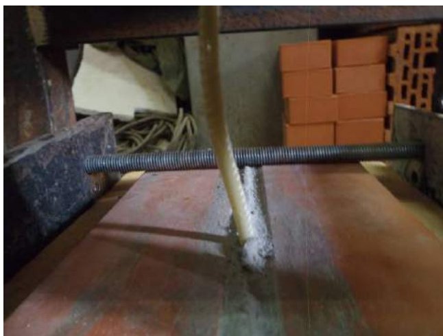
Фото 28. Положение анкера после сжатия в растворе шва под нагрузкой.
