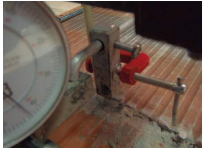
Фото 60. Образец-двойка керамического камня Роу-мах-200 со швом, армированным стальной сеткой.
