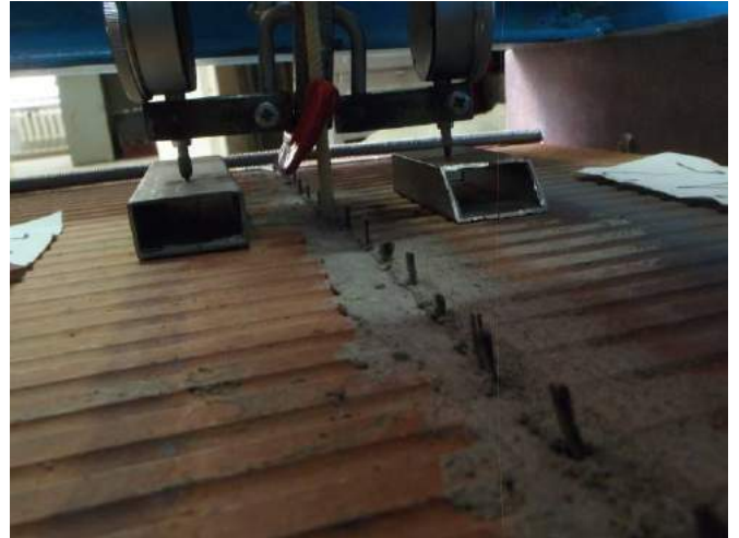
Фото 74. Образец-двойка из керамического камня Рогомах-200 со швом, армированным базальтовой сеткой 12 мм.
