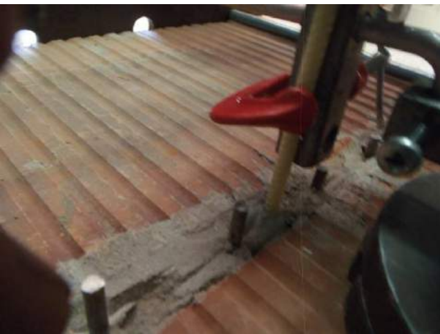
Фото 57. Вид анкера с крепежным приспособлением для индикатора (регистрации перемещений).
