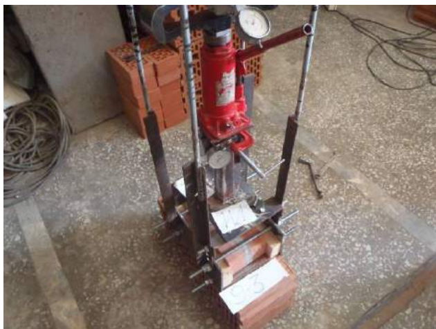
Фото 5. Стенд 3 для испытания композитных гибких связей на прочность при сжатии.
