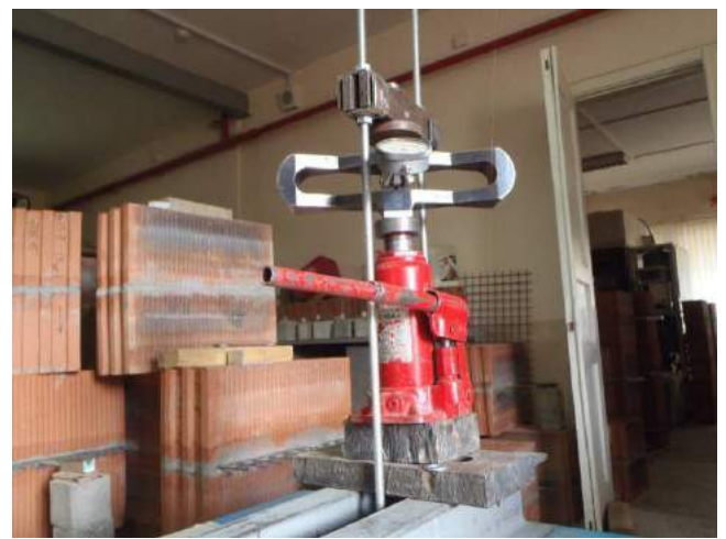
Фото 4. Статическое нагружение анкеров создается домкратом пошагово, равными ступенями, с фиксацией нагрузки механическим динамометром ДОСМ 3-5.
