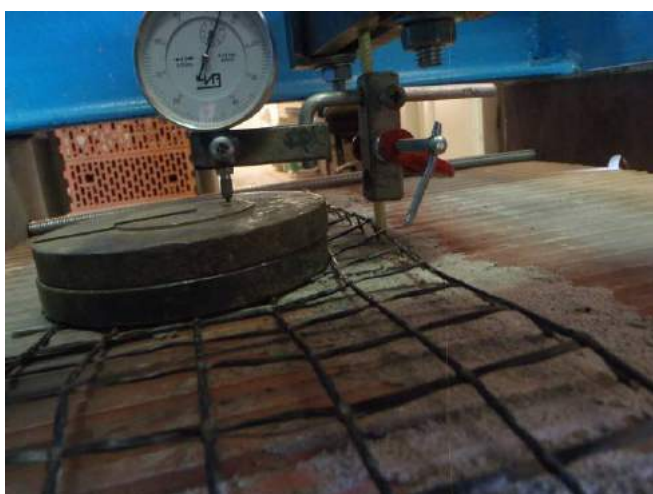
Фото 35. Фиксация перемещений полимерного анкера.
