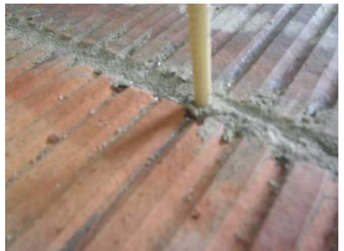
Фото 6. Положение анкера после сжатия под действием нагрузки. Критерием предельного перемещения анкера при испытании образца на сжатие является величина, превышающая 5 мм или не прекращающиеся деформации при уменьшении нагрузки.
