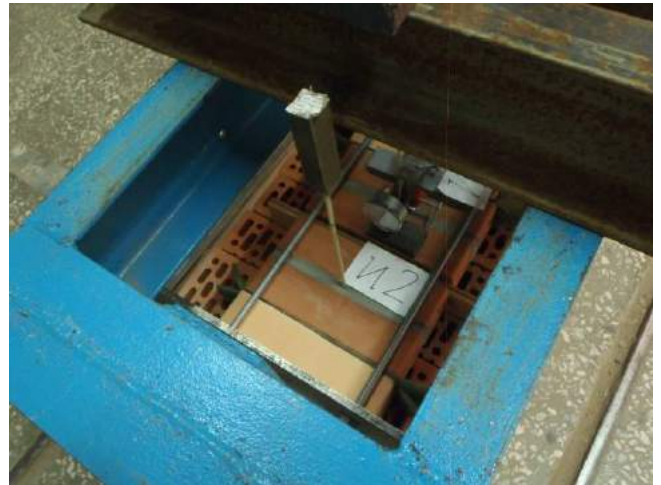
Фото 44. Индикатор И2 фиксирует перемещения полимерного анкера из шва образца при испытании на прочность при растяжении.
