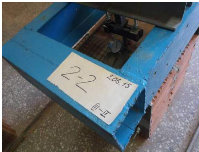
Фото 34. Испытание 2 серии 2. Образец-двойка из керамического камня РОЮМ АХ-200 с базальтовой сеткой в растворе шва.
