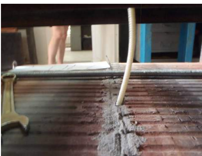
Фото 48. Положение анкера после сжатия в растворе шва под нагрузкой.
