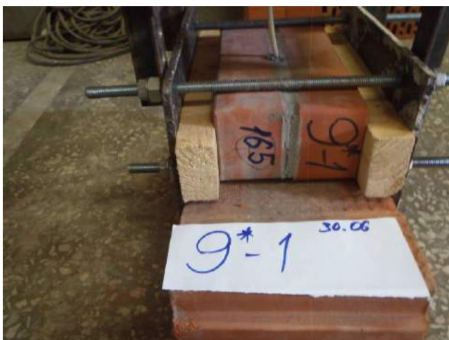
Фото 35. Образец-двойка кирпича лицевого 0,7 НФ Евро с укороченной заделкой анкера в стандартном растворном шве 10 мм.
