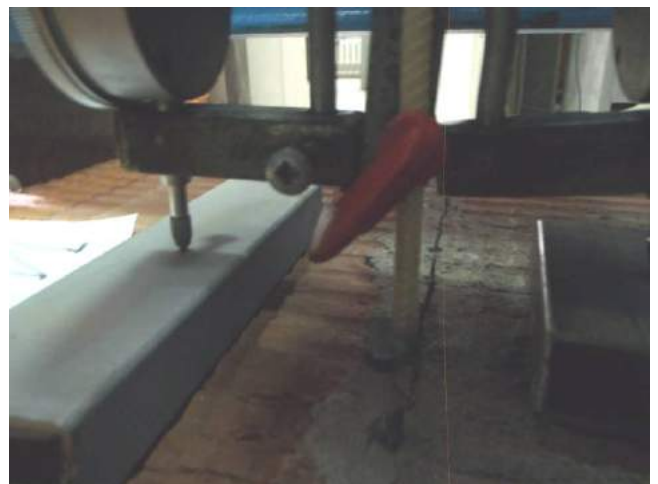
Фото 72. Положение анкера после испытания образца. Видно выкрашивание частиц раствора из шва при вытягивании.
