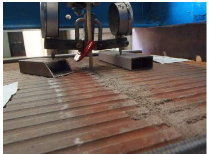
Фото 68. Индикаторы часового типа для контроля перемещений при загрузении элементов испытываемых образцов.
