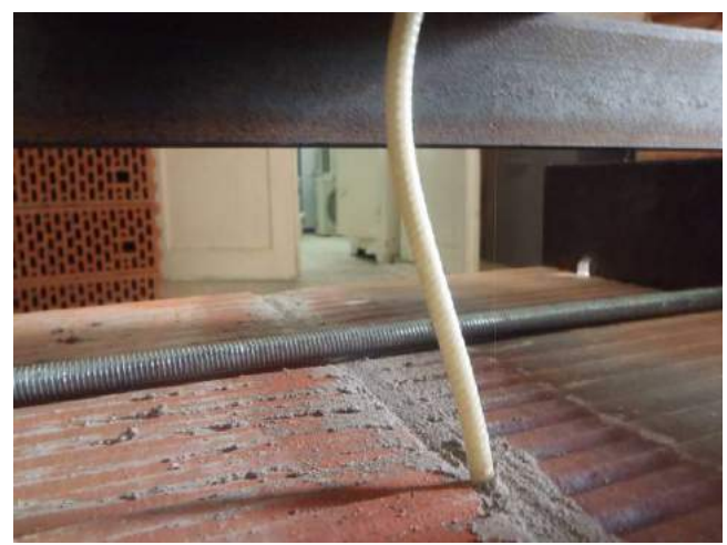
Фото 23. Стержень полимерного анкера после приложения нагрузки.
