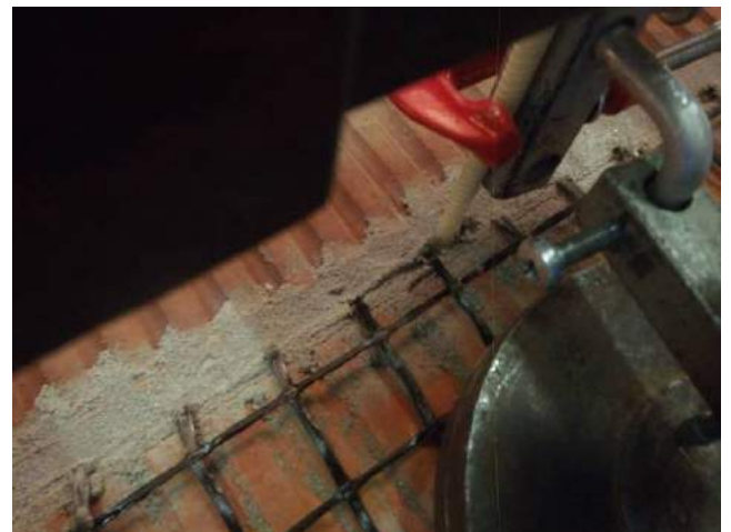
Фото 42. Образец-двойка из керамического камня Рогом ах-200 с базальтовой сеткой в растворе шва.
