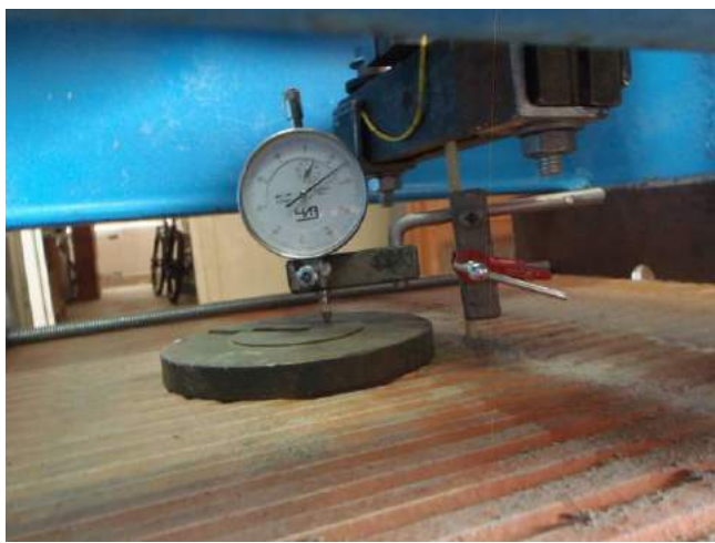
Фото 3. Индикатор часового типа для контроля перемещений при загрузке элементов испытываемых образцов.
