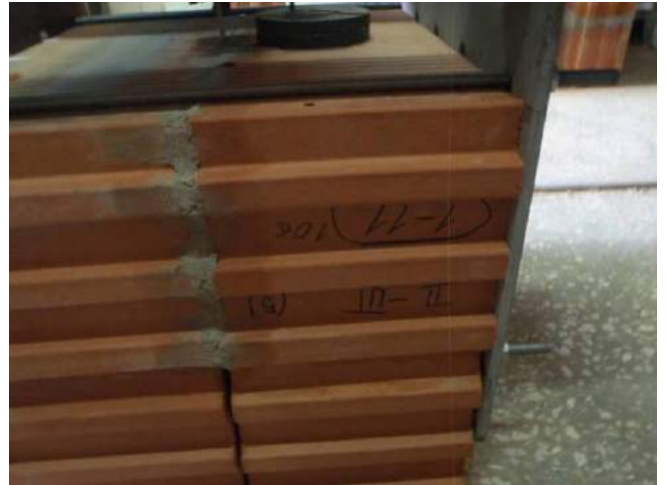
Фото 28. Образец-двойка керамического камня Роммах-200 со стандартным раствором швом 10 мм.
