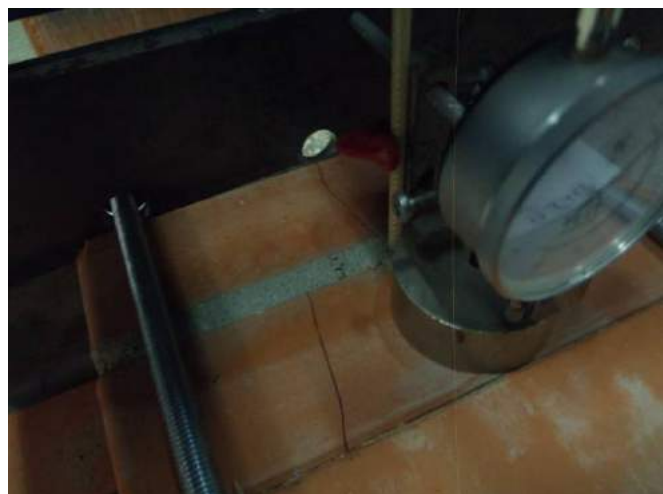
Фото 14. Индикатор фиксирует перемещения полимерного анкера из образца при испытании.
