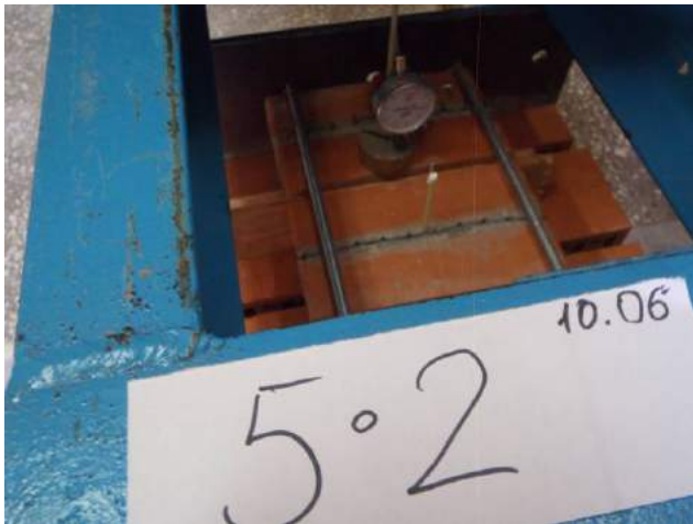
Фото 31. Образец-двойка кирпича лицевого 0,7 НФ Евро со швом, армированным базальтовой сеткой 12 мм .
