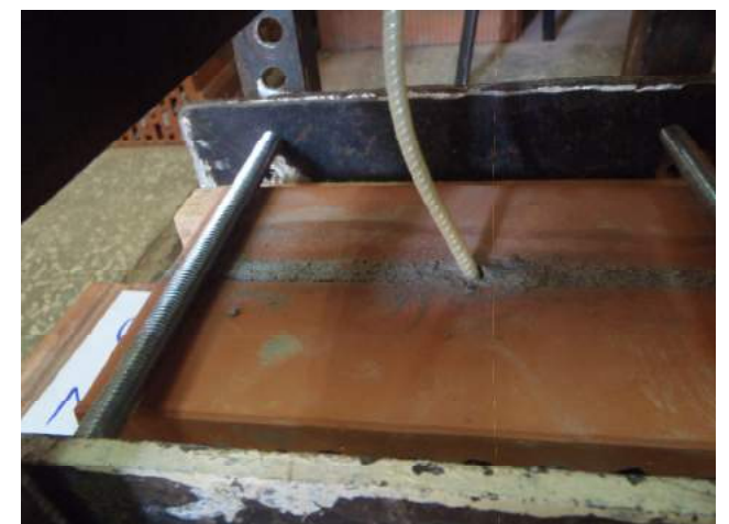
Фото 42. Анкер после испытания. Видно выкрашивание раствора из шва образца.
