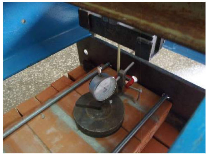
Фото 8. Индикатор часового типа для контроля перемещений при загрузке элементов испытываемых образцов.
