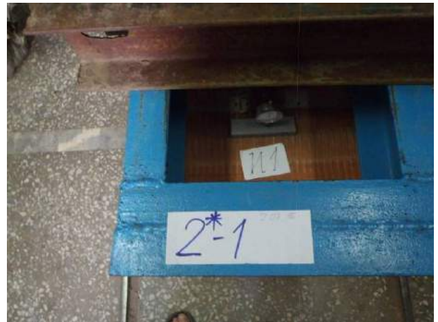
Фото 70. Испытание 1 серии 2*. Укороченная заделка анкера в растворе шва образца-двойки.
