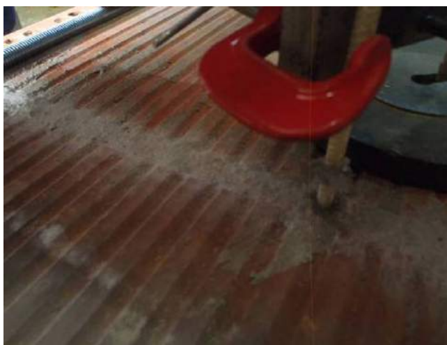
Фото 6. Критерием разрушения при вытягивании связи являются: разрыв связи, разрушение кладки, перемещение анкера более 5 мм или не прекращающиеся перемещения без увеличения нагрузки.
