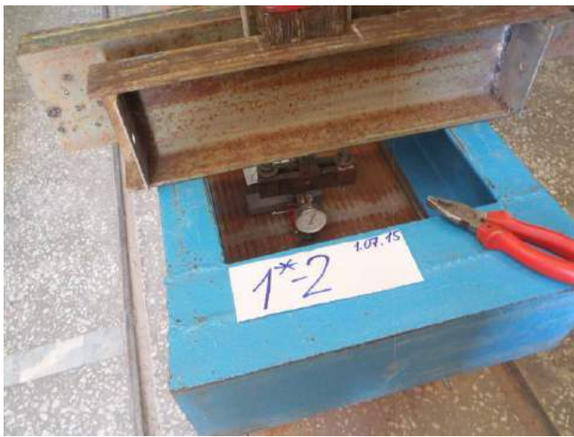
Фото 67. Испытание 2 серии 1*. Укороченная заделка анкера в растворе шва образца.
