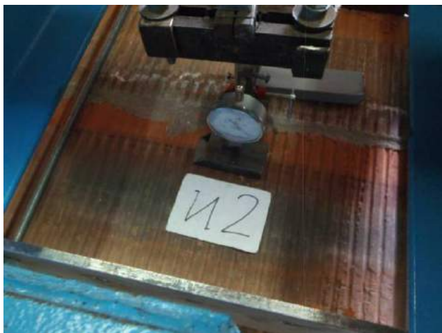
Фото 65. Образец-двойка из керамического камня Роям АХ-200. Укороченная заделка анкера в растворе шва образца-двойки.
