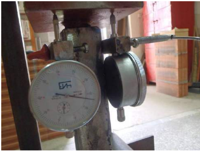
Фото 19. Индикаторы фиксируют подвижки и перемещения полимерного анкера при сжатии в образце при испытании.
