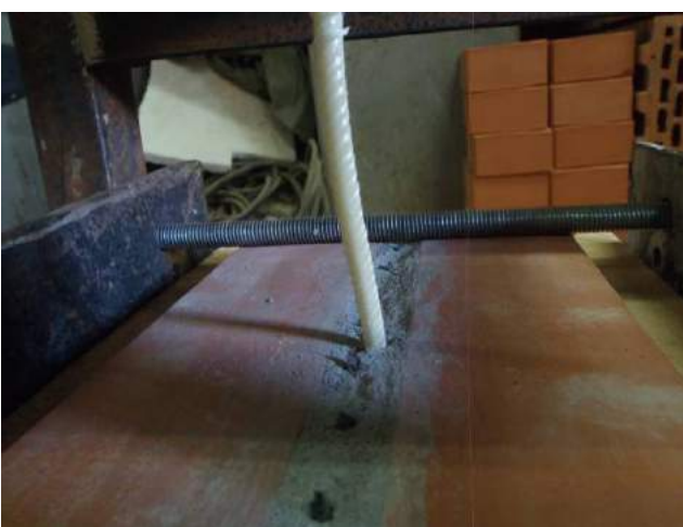
Фото 23. Положение анкера после сжатия в растворе шва под нагрузкой.
