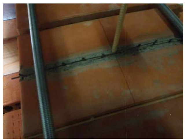
Фото 30. Положение анкера после вырыва из образца. Видно растрескивание кирпича в месте заделки анкера в шве под действием нагрузки.
