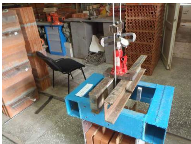
Фото 15. Стенд 1 для испытания композитных гибких связей на прочность при растяжении (вытягивающие нагрузки).
