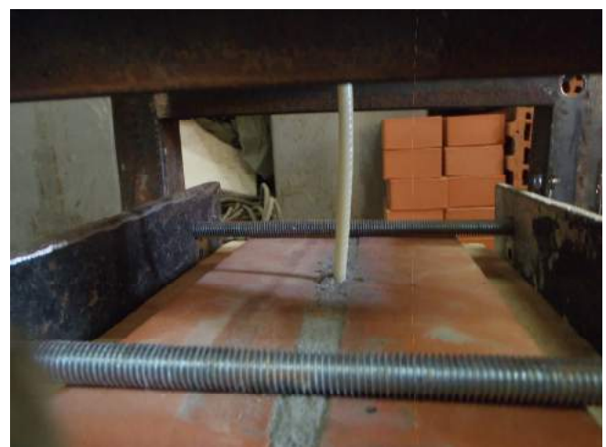
Фото 40. Положение анкера после сжатия в растворе шва.
