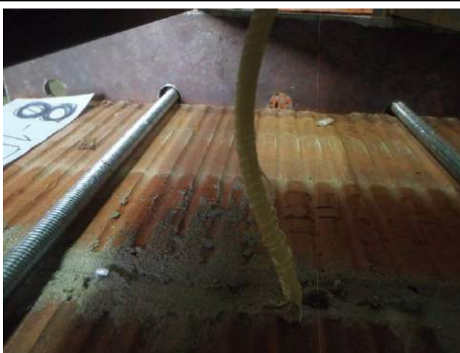
Фото 53. Положение анкера после сжатия в растворе шва под нагрузкой. Виден обрыв навивки полимерного анкера при сжатии.
