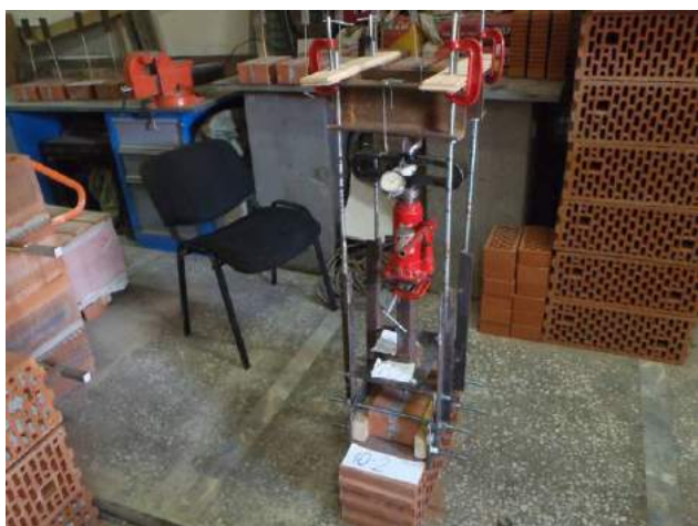
Фото 21. Общий вид стенда. Испытывается образец №2 серии 10. Шов с базальтовой сеткой.
