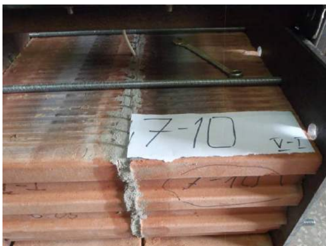
Фото 45. Испытание образца №10 серии 7 (образец-двойка керамического камня РОКОМАХ-200 со швом, армированным базальтовой сеткой 12 мм).
