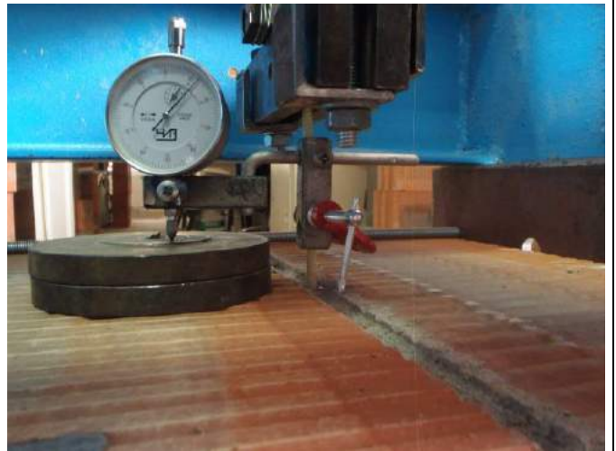
Фото 8. Вид анкера с прикрепленным индикатором для регистрации перемещений.
