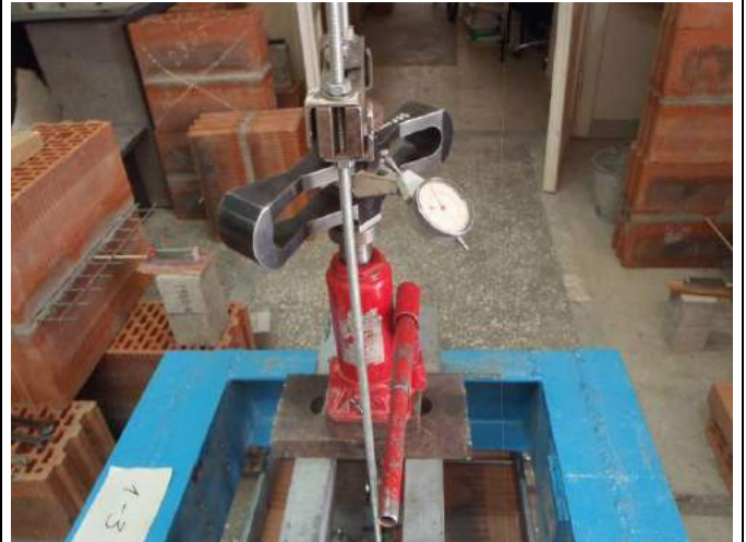
Фото 14. Производится ступенчатое нагружение очередного образца с фиксацией по шкале индикатора ДОСМ.
