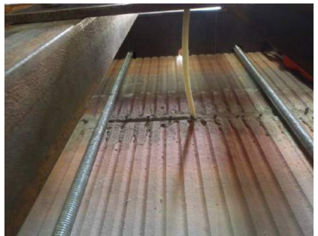
Фото 40. Положение анкера после сжатия в шве под действием нагрузки.
