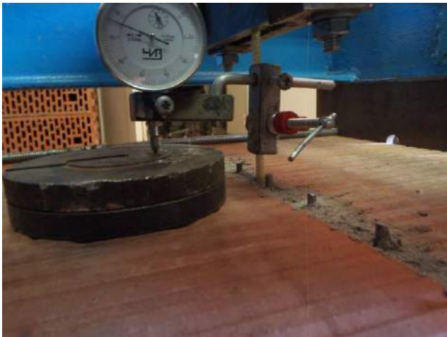
Фото 55. Фиксация перемещений полимерного анкера.
