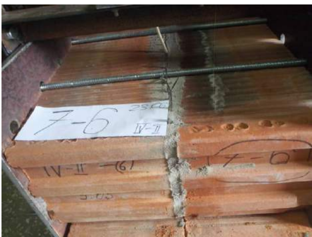
Фото 41. Образец-двойка из керамического камня Рогом ах-200 со швом, армированным базальтовой сеткой 12 мм.
