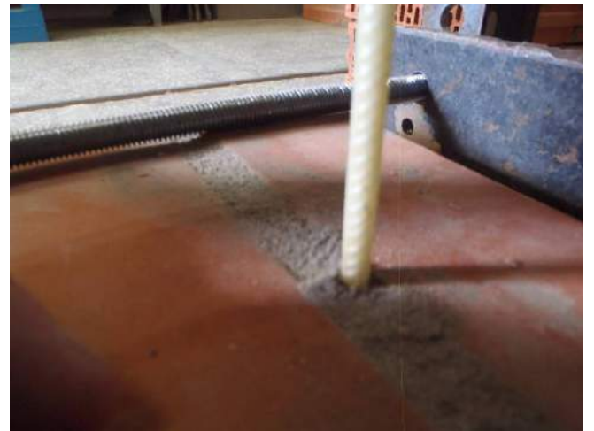
Фото 10. Положение анкера после сжатия в растворе шва под нагрузкой. Видно обмятие раствора шва вокруг стержня.
