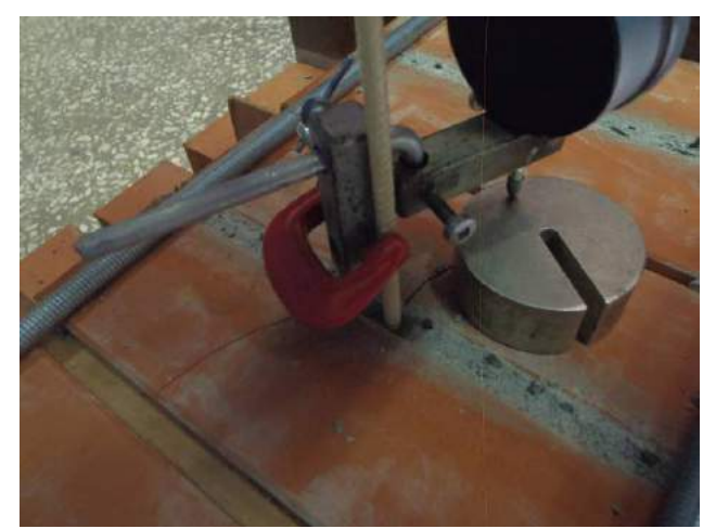
Фото 36. Положение анкера после испытания образца на вырыв. Видно растрескивание кирпича в месте заделки анкера в шве под действием нагрузки.
