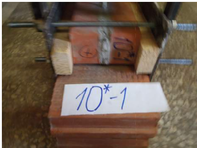
Фото 43. Образец-двойка кирпича лицевого 0,7 НФ Евро с укороченной заделкой анкера в шве, армированном базальтовой сеткой 12 мм.
