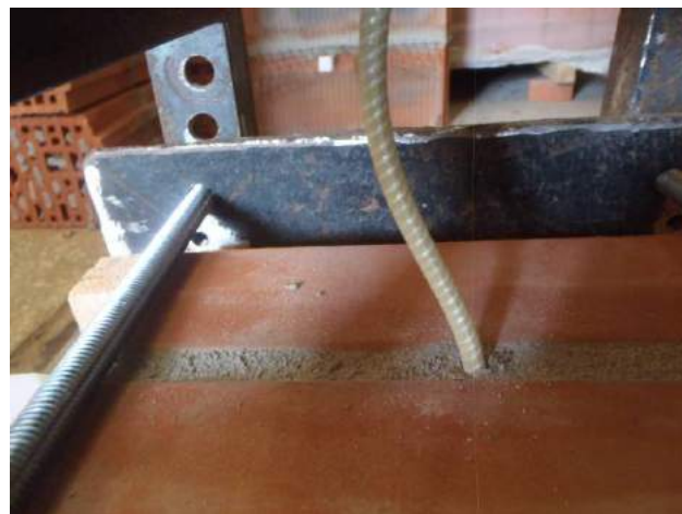
Фото 14. Положение анкера после сжатия в растворе шва под нагрузкой.
