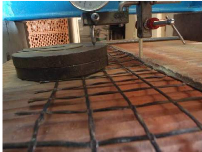
Фото 32. Образец-двойка из керамического камня РОЮМ АХ-200 с базальтовой сеткой в растворе шва.
