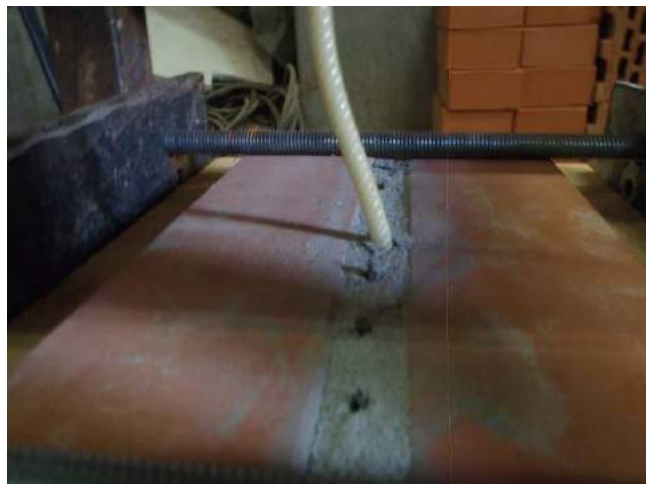
Фото 26. Стержень полимерного анкера после приложения нагрузки.
