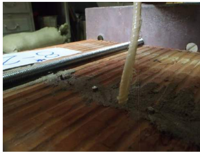
Фото 62. Положение анкера после сжатия в растворе шва под нагрузкой. Виден обрыв стекловолоконного шнура полимерного стержня.
