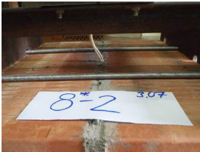
Фото 61. Испытание образца №2 серии 8* (образец-двойка керамического камня РОЖМАХ-200 с укороченной заделкой стержня в шве, армированном стальной сеткой 14-16 мм). Разрушение стержня под действием нагрузки.
