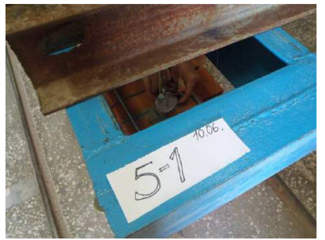
Фото 28. Общий вид стенда. Испытание образца №1 серии 5. Растворный шов армирован базальтовой сеткой.
