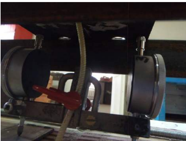
Фото 5. Деформация стержня (потеря устойчивости формы) полимерного анкера после приложения сжимающей нагрузки.
