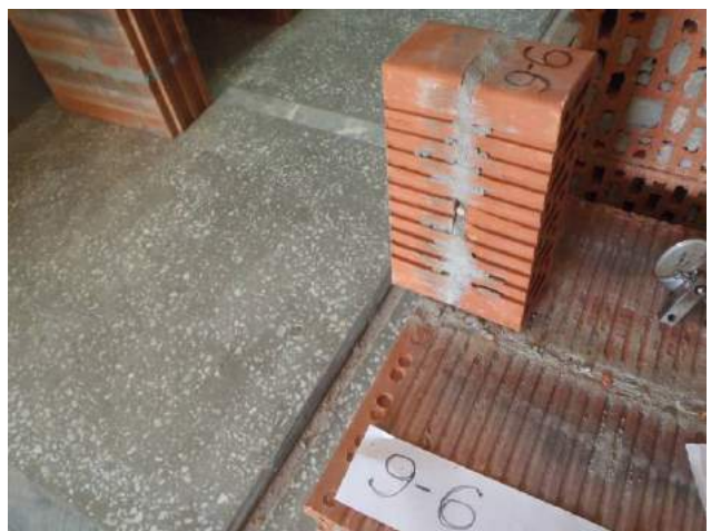
Фото 11. Под действием сжимающей нагрузки стержень провалился в растворе шва до низа образца-двойки.
