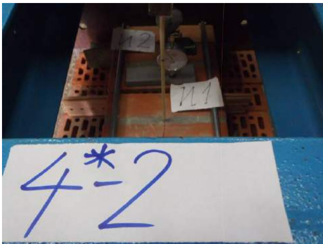
Фото 49. Общий вид стенда. Испытание образца №2 серии 4* (дополнительные образцы с укороченной длиной анкеровки).
