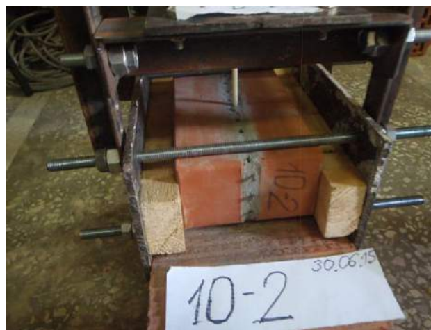
Фото 22. Образец-двойка кирпича лицевого 0,7 НФ Евро со швом, армированным базальтовой сеткой 12 мм.
