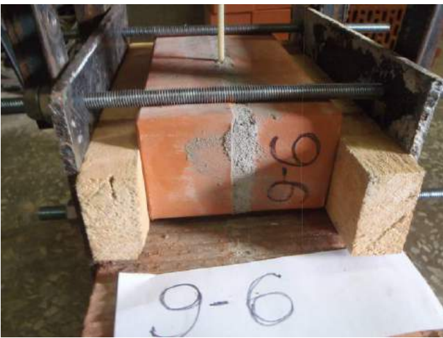
Фото 9. Образец-двойка кирпича лицевого 0,7 НФ Евро со стандартным раствором швом 10 мм.
