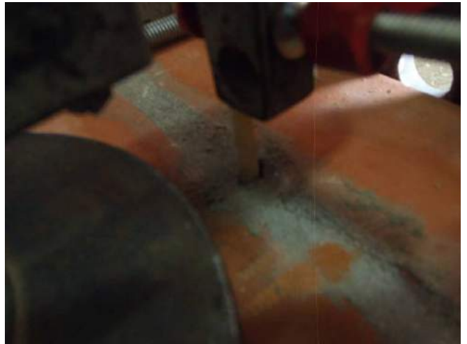
Фото 10. Положение анкера после вырыва из образца. Видно выкрашивание частиц раствора из шва при растяжении под нагрузкой.
