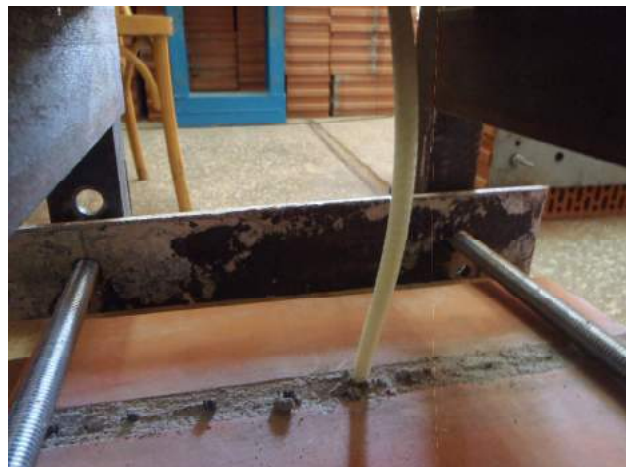
Фото 48. Положение анкера после сжатия в растворе шва под нагрузкой.
