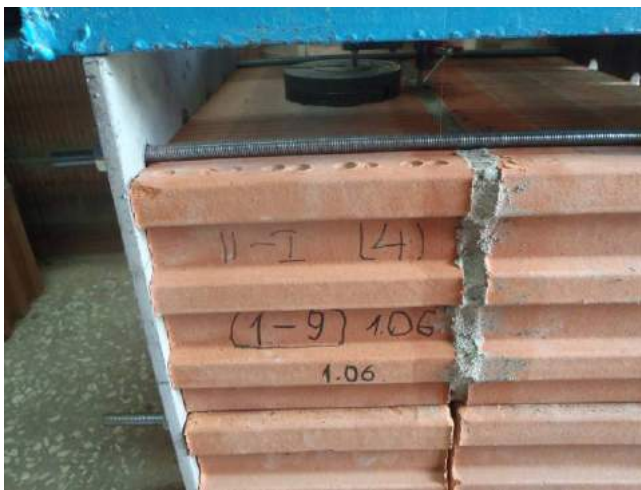
Фото 21. Образец-двойка керамического камня Роюмах-200 со стандартным раствором швом 10 мм.
