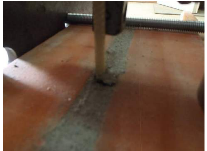
Фото 22. Критерием предельного перемещения анкера при вырыве из образца является величина, превышающая 5 мм или не стабилизирующиеся деформации связи.
