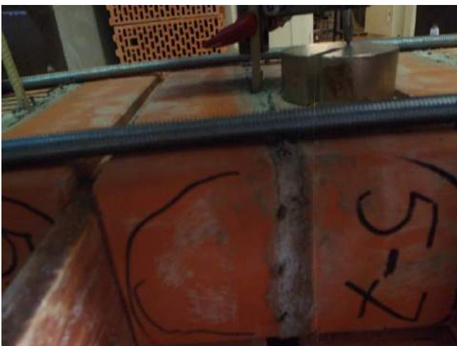
Фото 35. Образец-двойка кирпича лицевого со швом, армированным базальтовой сеткой 12 мм.
