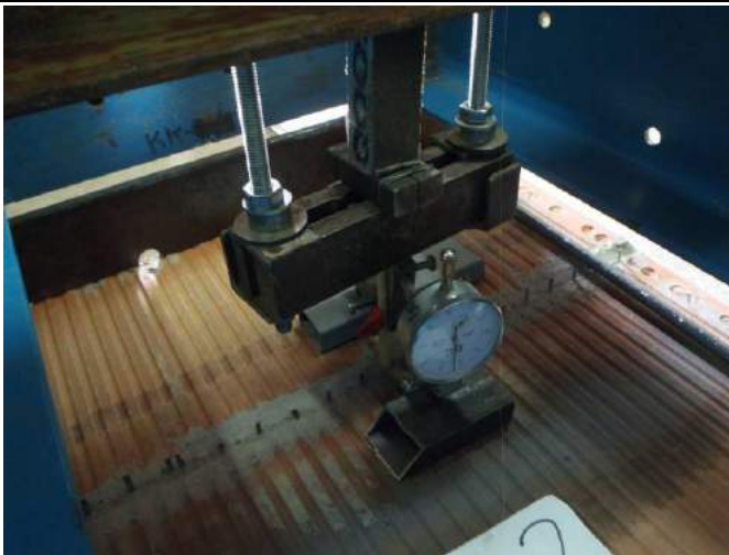
Фото 75. Вид анкера с крепежным приспособлением для индикатора (регистрации перемещений).
