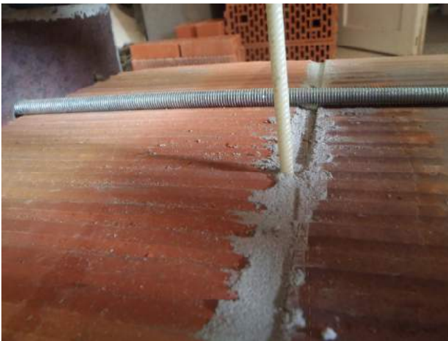
Фото 15. Образец-двойка керамического камня Рогом ах-200 со стандартным раствором швом 10 мм.
