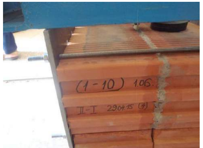
Фото 24. Образец-двойка керамического камня Роюмах-200 со стандартным раствором швом 10 мм.
