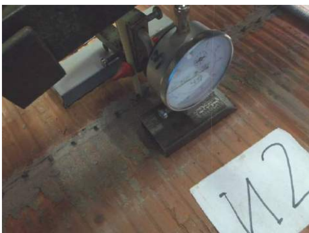
Фото 71. Образец-двойка из керамического камня Рюмах-200 со швом, армированным базальтовой сеткой 12 мм.
