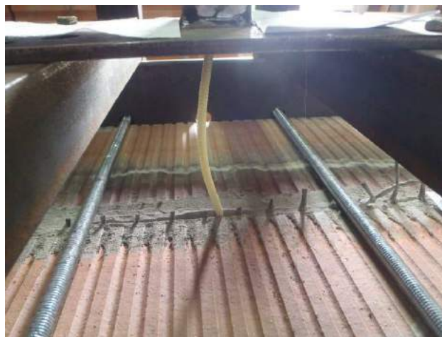
Фото 44. Положение анкера после сжатия в образце под действием нагрузки.
