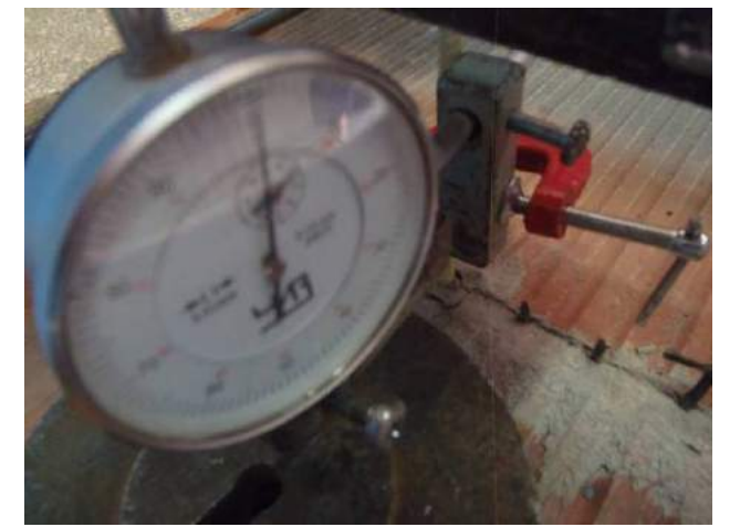
Фото 48. Фиксация перемещений по шкале индикатора часового типа.
