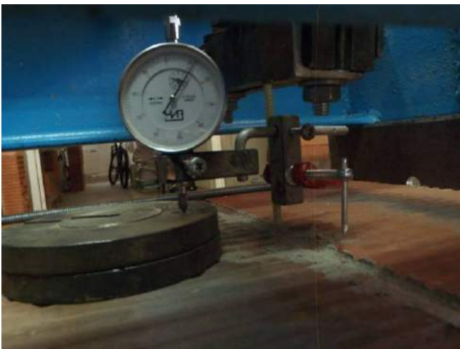
Фото 15. Индикатор показывает перемещения при испытании анкера из образца-двойки при нагружении.
