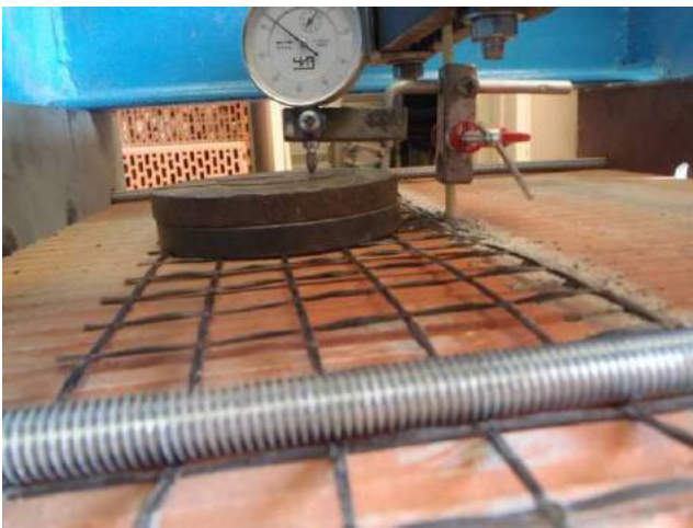
Фото 39. Установка индикаторов часового типа для контроля перемещений при загрузке анкера на испытательном стенде.
