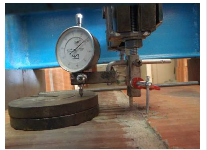
Фото 12. Фиксация перемещений анкера из шва образца-двойки при растяжении выполняется индикатором часового типа.
