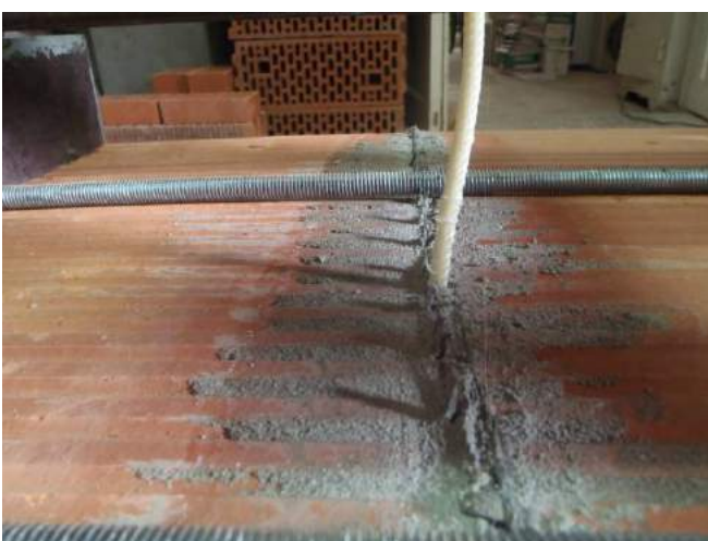
Фото 35. Стержень полимерного анкера после приложения нагрузки.
