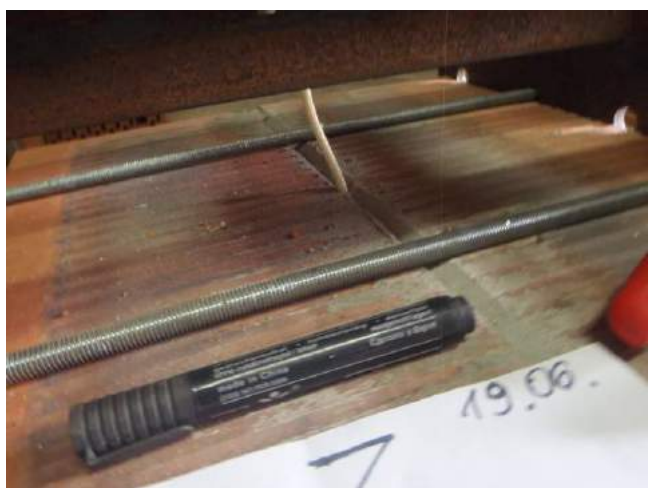
Фото 11. Образец-двойка керамического камня Рогомах-200 со стандартным раствором швом 10 мм.
