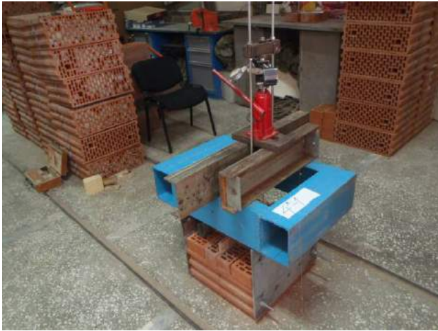
Фото 43. Стенд 1 для испытания композитных гибких связей на прочность при растяжении.
