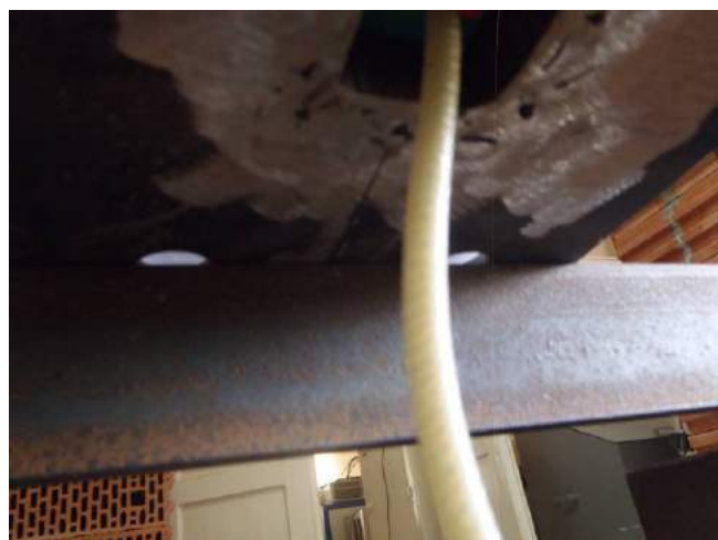
Фото 8. Стержень полимерного анкера после приложения нагрузки.
