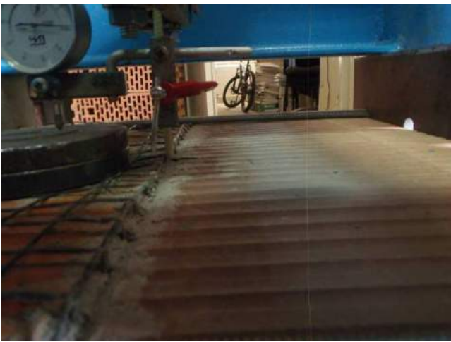
Фото 45. Фиксация перемещений полимерного анкера индикатором часового типа.
