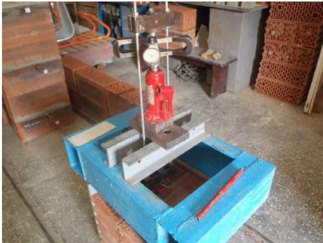
Фото 31. Испытательный стенд 1 для керамического камня РОЮМ АХ-200.
