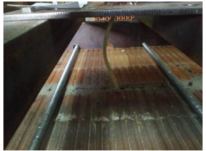
Фото 52. Стержень полимерного анкера после приложения нагрузки.
