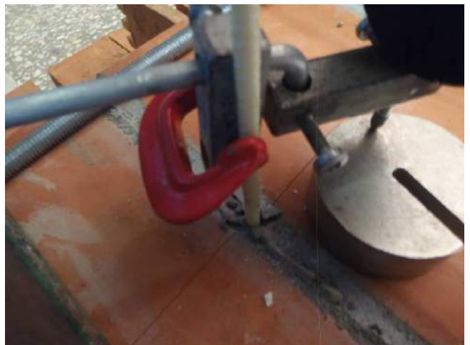
Фото 42. Положение анкера после вырыва из образца. Видно растрескивание кирпича в месте заделки анкера в шве под действием нагрузки.
