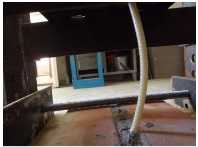
Фото 32. Стержень полимерного анкера после приложения нагрузки.
