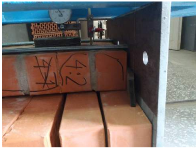
Фото 9. Образец-двойка кирпича лицевого 0,7 Евро со стандартным раствором швом 10 мм.
