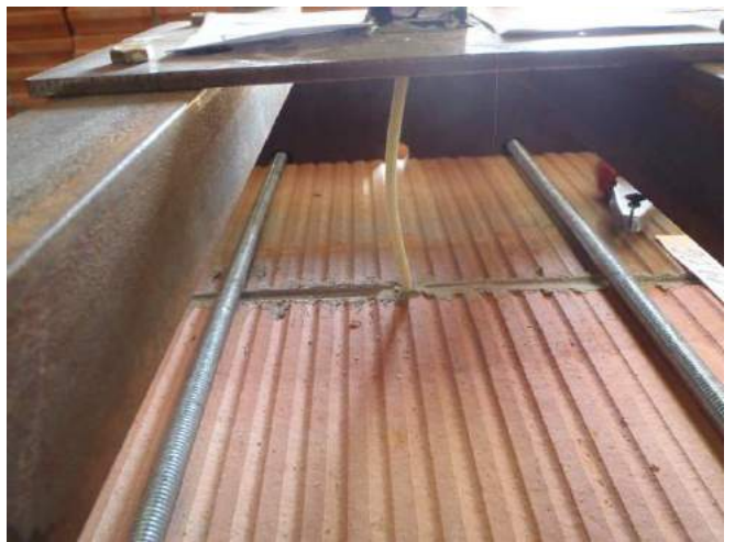
Фото 16. Производится ступенчатое нагружение очередного образца (сжатие).
