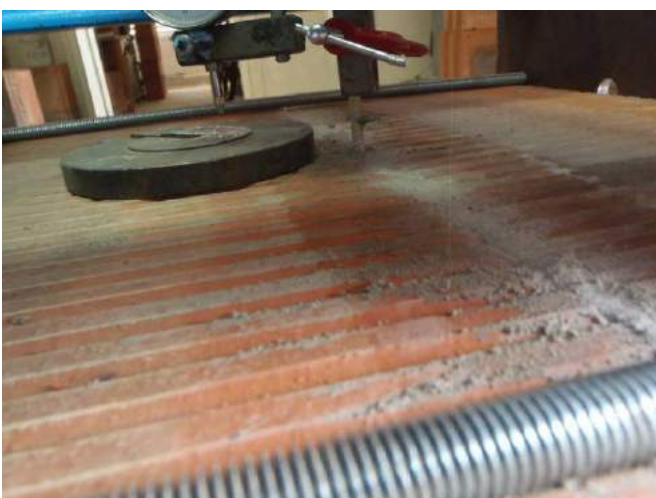
Фото 5. Индикатор фиксирует подвижки и перемещения полимерного анкера из образца при испытании на прочность при растяжении.
