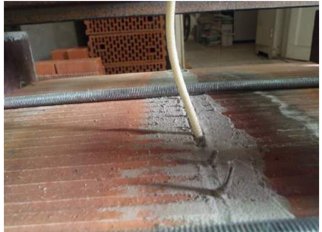
Фото 42. Стержень полимерного анкера после приложения нагрузки.
