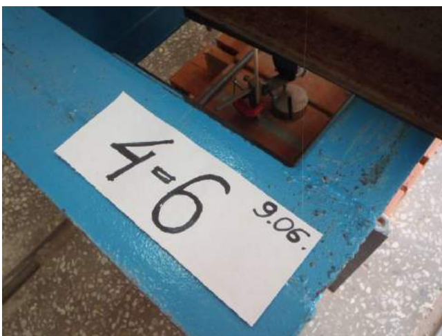
Фото 23. Испытание образца №6 серии 4 (образец-двойка кирпича лицевого 0,7 НФ Евро со стандартным раствором швом 10 мм).
