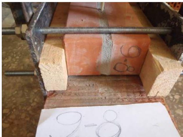
Фото 13. Образец-двойка кирпича лицевого 0,7 НФ Евро со стандартным раствором швом 10 мм.
